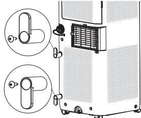
Napájací kábel omotajte okolo háčikov na napájací kábel.
