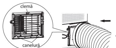
3. Dirijați tubul de evacuare a căldurii spre exterior.
