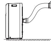
Udledningsrøret kan monteres efter brugerens ønske, mens monteringsform som vist nedenfor bør undgås, da det kan føre til uensartet udledning.
