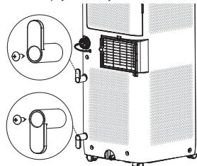
Omoutejte napájecí kabel kolem háků na napájecí kabel.
