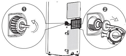
2. Helyezzen egy 13 mm belső átmérőjű tömlöt (nem tartozék) a vízelvezetőcsatlakozóra.
