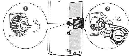
2. Introduceți un furtun cu diametrul interior de 13 mm (nu este inclus) la conectorul pentru drenaj.
