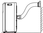
Tubul de evacuare poate fi instalat în funcție de cerințele utilizatorului, în timp ce forma de instalare ilustrată mai jos trebuie evitată, deoarece poate duce la o evacuare neuniformă.
