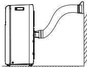
Odvodové potrubí lze instalovat dle požadavků uživatele, avšak měli byste se vyhnout níže zobrazené instalaci, protože to může mít za následek nejednotný odvod.
