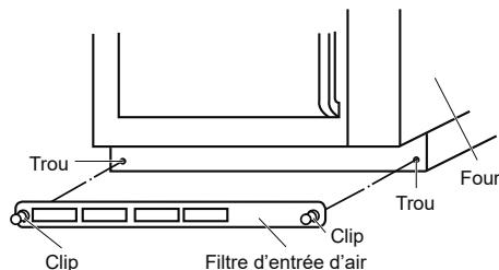
Veillez à ce que le filtre d'entrée d'air soit propre. Pour retirer le filtre vous devez libérer les deux (2) clips qui le maintiennent. Lavez le filtre dans une solution d'eau savonneuse puis essuyez-le avec un chiffon doux. Remettez le filtre en place après nettoyage. Nettoyez le filtre toutes les deux semaines.
