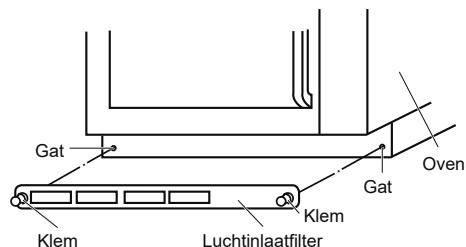
Houd het luchtinlaatfilter schoon. Voor het reinigen van het luchtinlaatfilter, trekt u de twee klemmen van het filter en verwijdert u vervolgens de luchtinlaatfilter.
