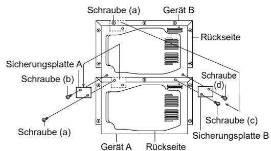
Abb. A: Verschrauben von zwei Mikrowellengeräten
