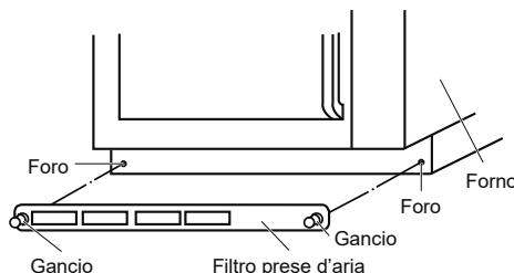
Mantenete sempre pulito il filtro delle prese d'aria. Per pulirlo, togliete il filtro delle prese d'aria tirando i due ganci sul filtro.
